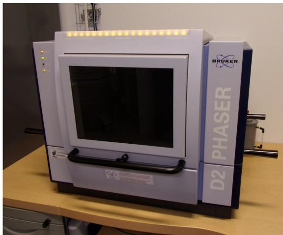
Diffractomètre de paillasse (80 kg)
