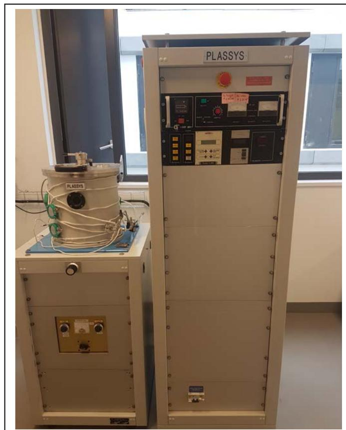
**Exemples d'analyses / d'applications :** Ce dépôt permet d'effectuer des mesures électriques sur des matériaux isolants ainsi que des images MEB sur ce même type de matériaux.
