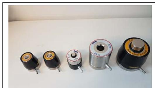
Matrices de compaction : 8mm, 10mm, 13mm, 20mm et 35mm
