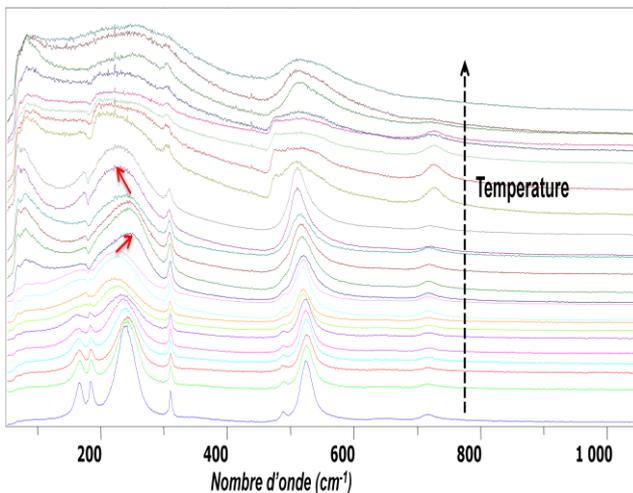
Spectre Raman d'un cristal de Titanate de Barium en fonction de la température et mise en évidence des transitions structurales.
