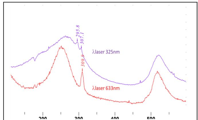
Spectre Raman d'un cristal de Titanate de Barium en fonction de la longueur d'onde incidente et donc de la profondeur de pénétration (40 nm dans l'UV et quelques micromètres dans le visible), mise en évidence d'une structure différente à la surface.
